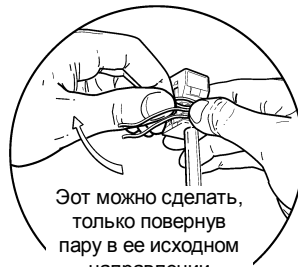
Рисунок 7: Заделка кабеля 61-Series в панель MPS100E
